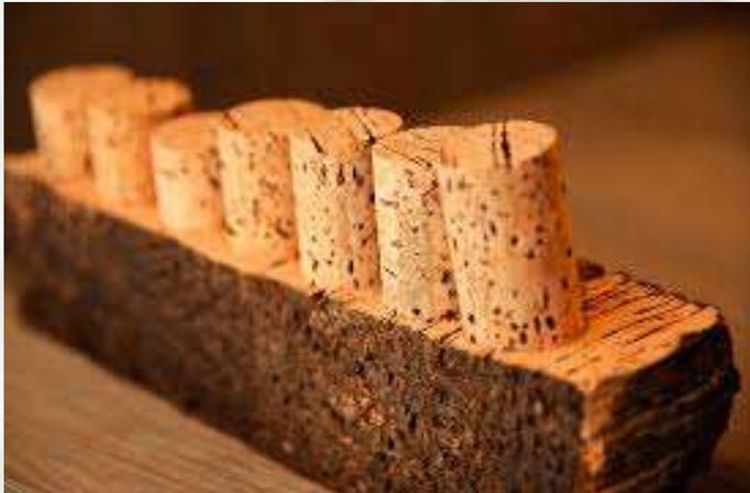
El colmatado de taponos de corcho natural se define como el proceso para rellenar las lenticelas (poros del corcho natural) con polvo de corcho y un fijador a base de caucho natural con el objetivo de mejorar el aspecto visual y la estanqueidad previniendo la oxidación del producto envasado
